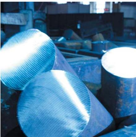
Schmieden ist das spanlose Umformen von Metallen zwischen zwei Werkzeugen. Die Wahl des Werkzeugstahles richtet sich in erster Linie nach dem jeweiligen Schmiedeverfahren.
